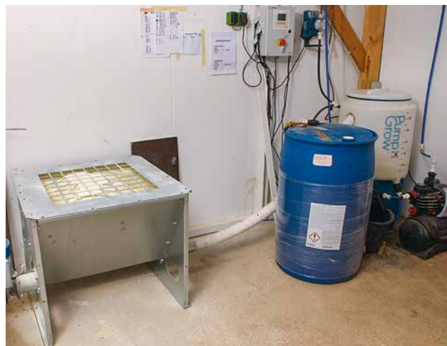
△ Eine Schnecke transportiert das Milchpulver vom Vorratstank (li.) zum Anmischbehälter (re.). In der blauen Tonne lagert Flüssigeisen.
